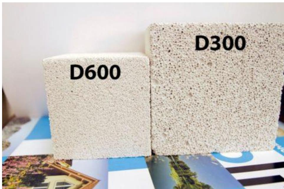
Рис.1 Блоки с разным показателем средней плотности, фото [5]
